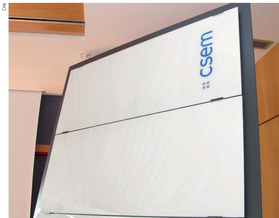
Figure 1 Prototypes de modules photovoltaïques blancs réalisés au CSEM.
